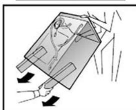
Поставьте крышку на место, двигая ее в горизонтальном направлении вперед и закрепите ее винтами **A**.
